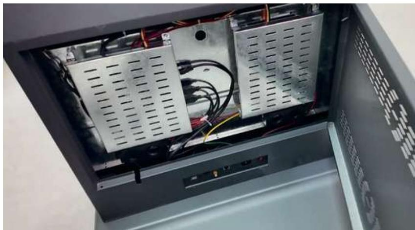
Branchez d'abord l'antenne, puis le câble d'alimentation et allumez l'appareil. Vous verrez également un emplacement pour brancher directement un câble réseau, ainsi que deux ports USB 2.0. Les clés fournies dans le kit permettent d'ouvrir le panneau arrière afin d'accéder à la mémoire et au processeur.
