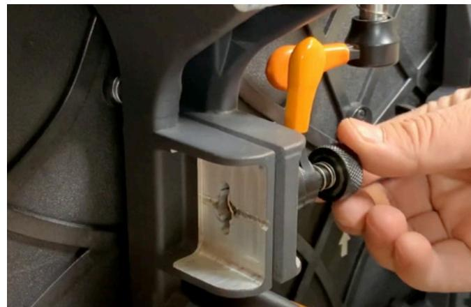
2.2) Drehen Sie anschließend den Hebel, um das horizontale System zu verriegeln.
