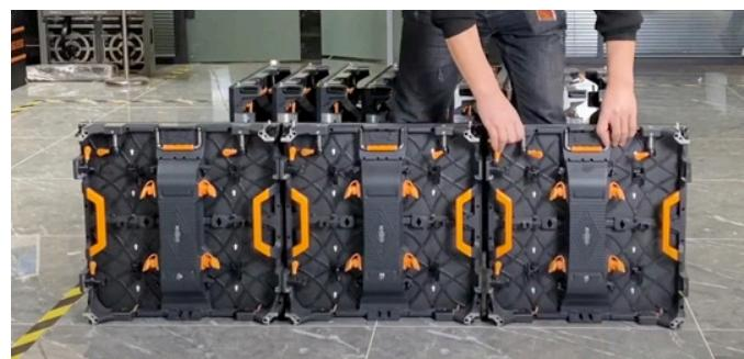
3) Die vertikale Anordnung der Bildschirme erfolgt auf die gleiche Weise wie die horizontale Anordnung mit Hilfe von Sicherheitsschlössern. Sichern Sie die Bildschirme einzeln, sowohl innerhalb der Spalte als auch über die Zeile hinweg.
