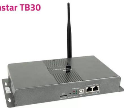
Wenn Sie nach einem fortschrittlichen und effizienten Modell suchen, ist der **Novastar TB30** eine ausgezeichnete Option. Mit ähnlichen Kernmerkmalen, wie einer Ladekapazität von bis **650.000 Pixeln**, unterstützt dieses Modell auch eine maximale Breite von **4096 Pixeln** und eine maximale Höhe von **1920 Pixeln**.
